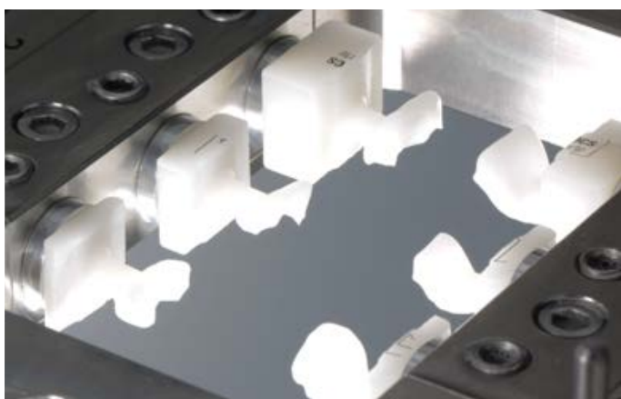
III. 9 : six blocs VITABLOCS TriLuxe forte usinés dans le support de bloc.
