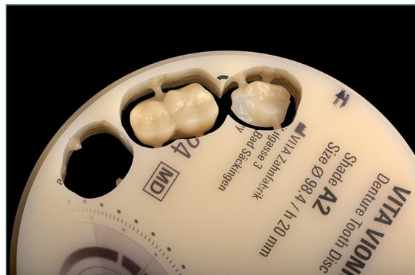
Le matériau dentaire fabriqué par CFAO dans le VITA VIONIC DENT DISC multiColor.
